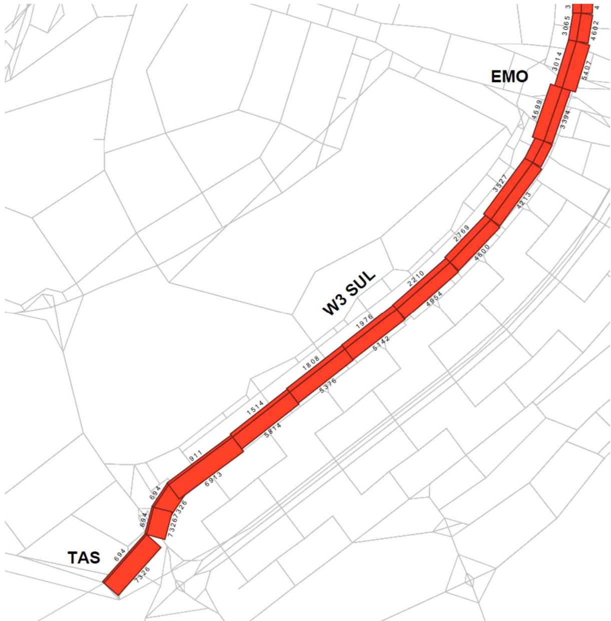
Figura 6.3.1.3 - Carregamento do Cenário 1 - Cenário Base Ano 2020 - VLT/Linha 1- Hora Pico da Manhã - Detalhe Trecho Sul
