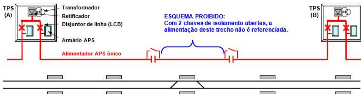
Figura 2-29 - Diagramas de segmentação elétrica proibida no APS
