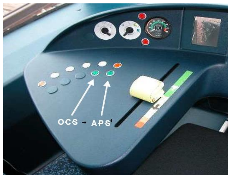
Figura 4-16 - Botões luminosos dos modos APS e OCS
