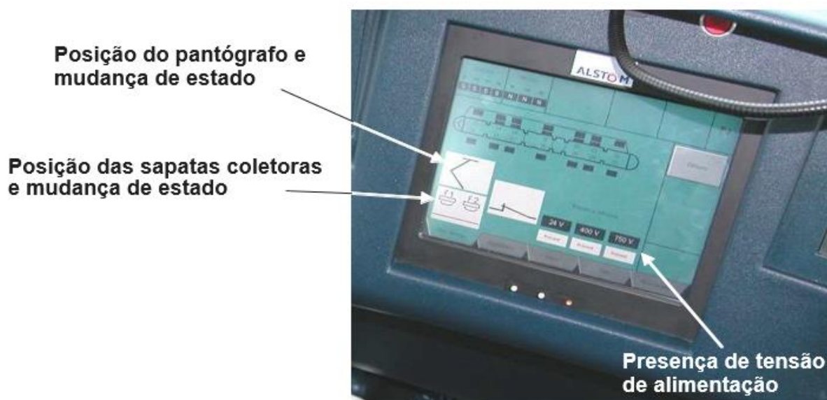
Figura 4-18 - Informação disponível no monitor da cabine do maquinista
