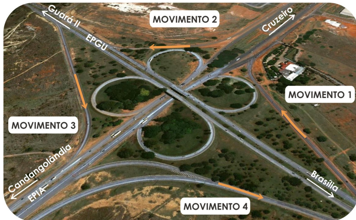
Figura 16: Localização dos movimentos no Ponto 13 – Interseção da DF-051 (EPGU) com a DF-003(EPIA)
