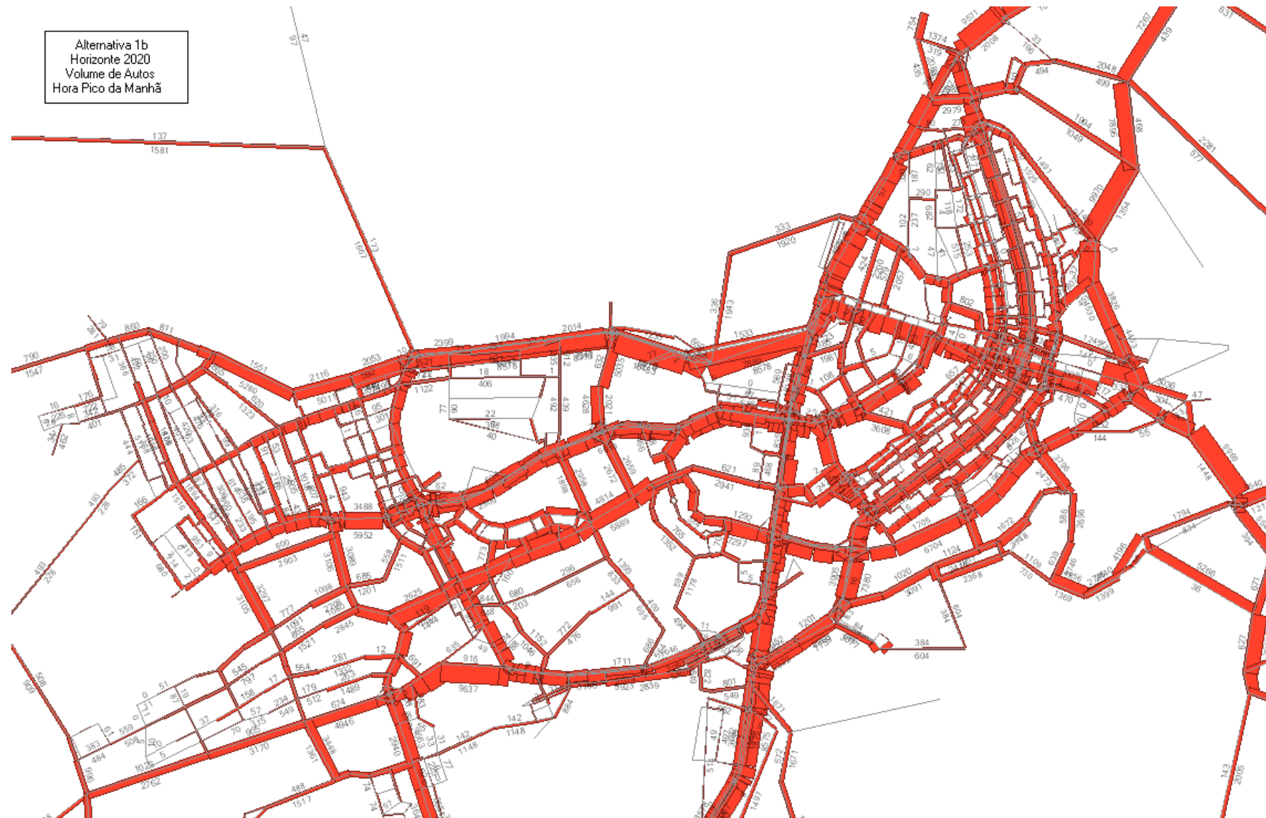
Figura 32: Carregamento de autos da alternativa 1b – 2020 (detalhe da área central)
