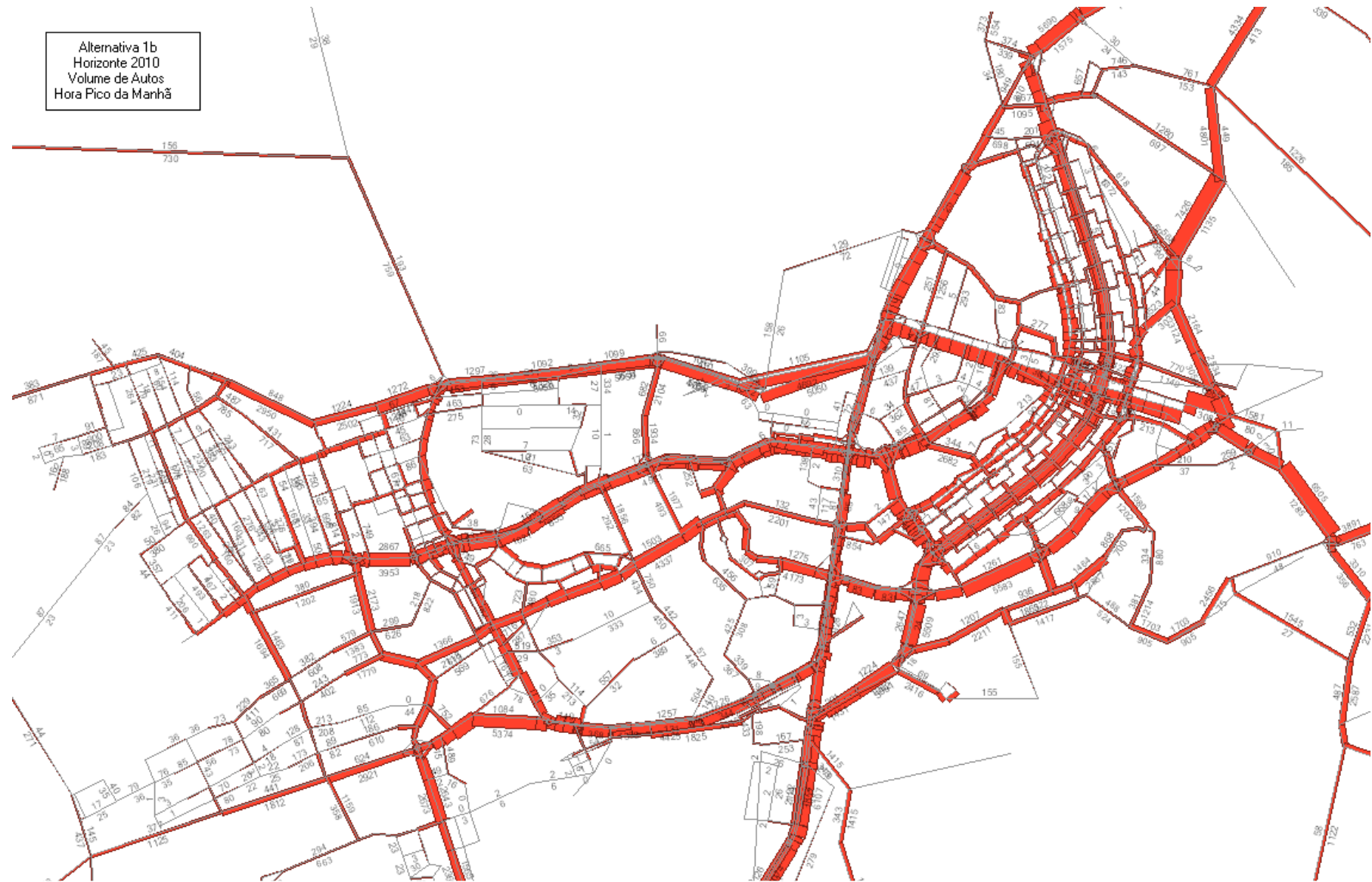
Figura 30: Carregamento de autos da alternativa 1b – 2010 (detalhe da área central)
